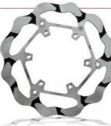
Il disco BATFLY® con profilo WAVE viene ora proposto con un'ulteriore evoluzione per adattarsi alle richieste dei piloti più esperti. Il collegamento pisto-mozzo disco viene lasciato libero in tre punti per permettere la dilatazione termica limitando comunque l'effetto di rotura frenata.
